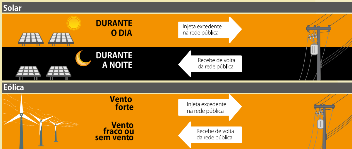
Figura 1 - Exemplos do funcionamento da micro e minigeração de energia solar e eólica
